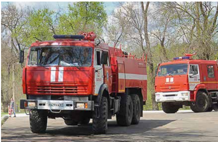
Автоцистерны тяжелого класса и высокой проходимости – КамАЗы и Уралы – вмещают до 8 т воды
