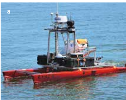
а – надводный автономный аппарат ROAZ; б – автономная капсула, буксирующая спасательное средство к месту обнаружения пострадавших
