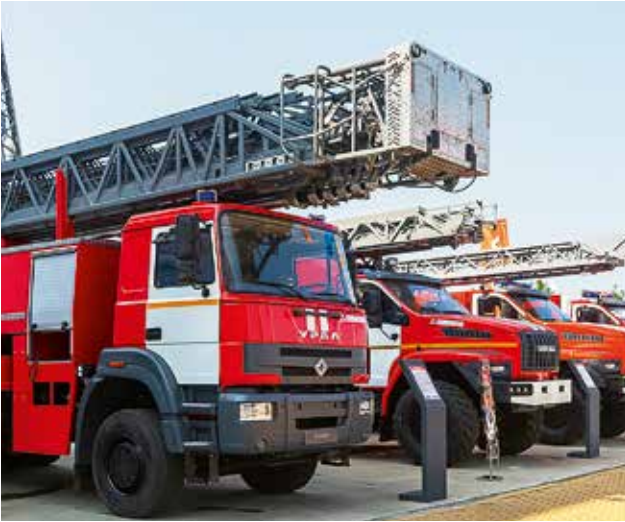
На базе автомобиля Урал была продемонстрирована уникальная 52-метровая лестница
