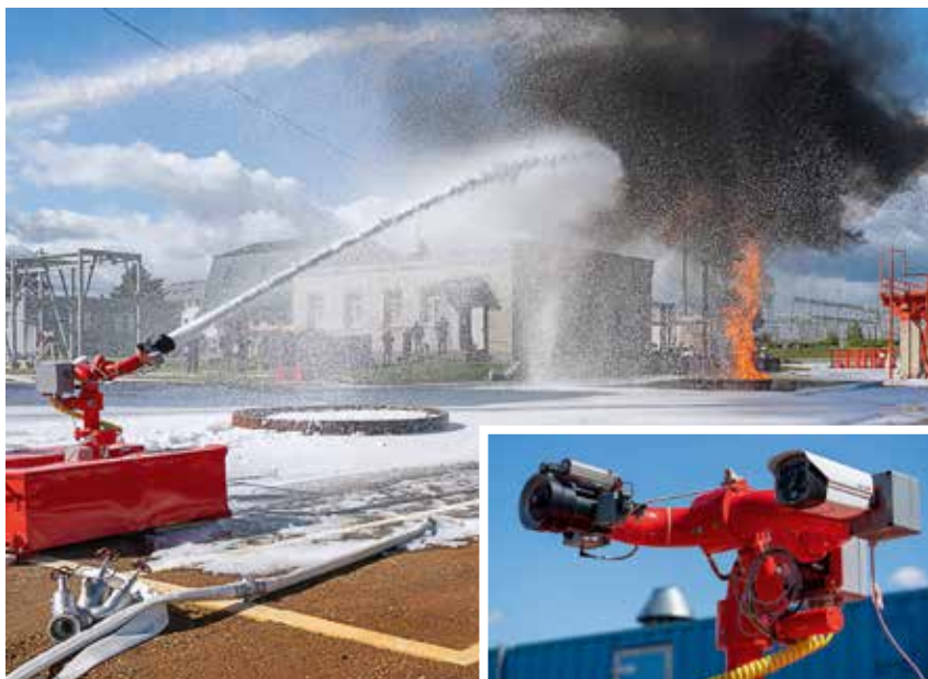
Испытания инновационного роботизированного комплекса противопожарной защиты с элементами искусственного интеллекта на Калининской АЭС, 2021 г.
