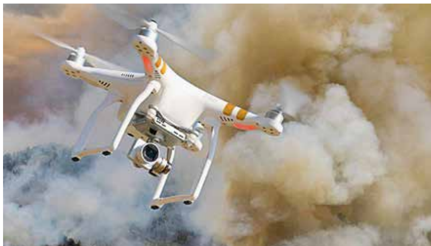
БПЛА определяет расстояние до очага возгорания и передает координаты на пульта пожарных подразделений
