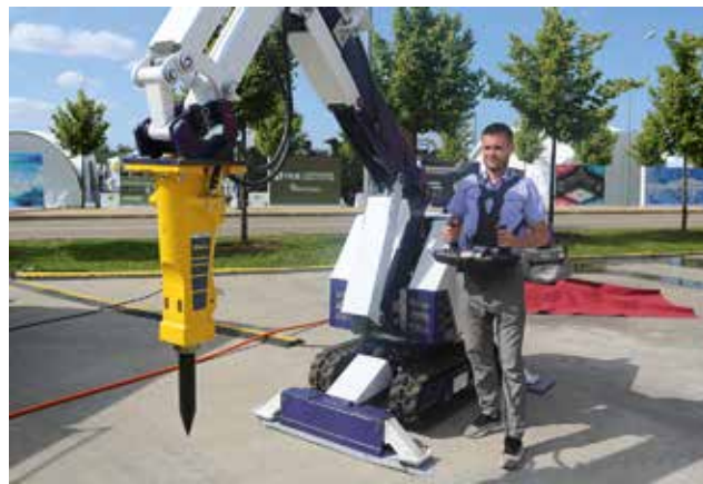
Дистанционно управляемый робот-манипулятор «Деморобот 2.0»
